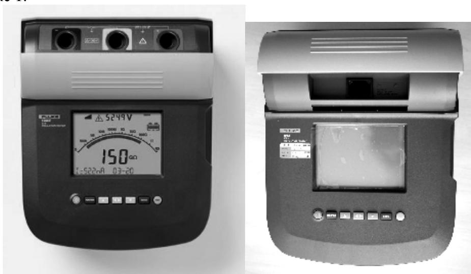
Рисунок 1 - Внешний вид измерителей сопротивления изоляции Fluke 1550C и Fluke 1555 при разных положениях защитной заслонки. Слева заслонка в рабочем положении – открыт доступ к разъемам для подключения измерительных проводов. Справа заслонка блокирует возможность подключения измерительных проводов и открывает стандартный разъем для сетевого провода, с его помощью внутреннее зарядное устройство заряжает аккумулятор.
